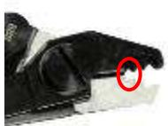
3. Exercer une traction longitudinale, ce qui provoque un glissement entre la partie 125 µm et le revêtement secondaire.
