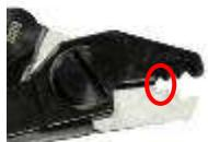
3. Exercer une traction longitudinale, ce qui provoque un glissement entre la partie 125 µm et le revêtement secondaire.
