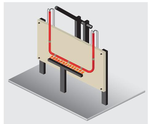
Pour les essais suivant les normes NFC 32070 (CR1) et EN 50200, le maintien de la transmission doit être effectif jusqu'à la fin de l'essai, et le maximum d'atténuation atteint ne doit pas être au-dessus des valeurs prescrites par la norme XP C93-539 (1 dB pour les fibres monomodes et 2 dB pour les fibres multimodes).
