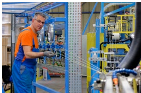
Atelier de fabrication des câbles « drop » de raccordement optique des abonnés (2019)
