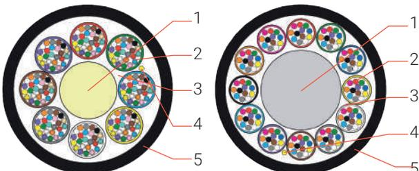
1. Zentrales GfK Stützelement
