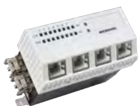
IB2000-04XP01 : MS 7 ports dont 4x1G en façade + 1xnG latéral + 2SFP10G
