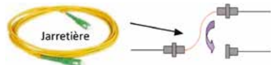
Principe de brassage d'une jarretière 1,6 ou 2mm
