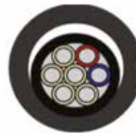
Section d'un fourreau avec micro-tubes assemblés
