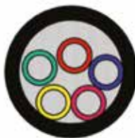
Section d'un fourreau PeHD avec micro-tubes indépendants
