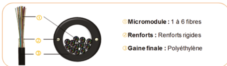
Vue en coupe d'un câble à accessibilité permanente
