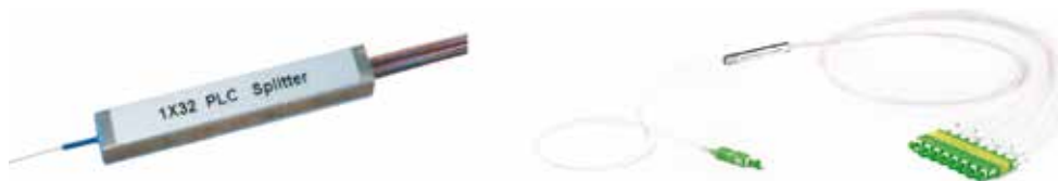
Coupleur 1x32 "nu" et coupleur 1x16 "nu" pré-connectorisé sans dispositif d'intégration pour réPRtiteur
